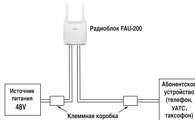
Рис. 2.3. Схема соединений АТ типа FAU 200.
