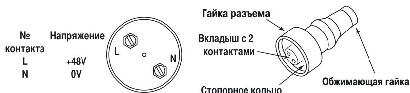
Рис. 2.8. Разъем кабеля питания.
