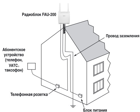
Рис. 2.1. Схема расположения элементов стационарного АТ типа FAU 200.
